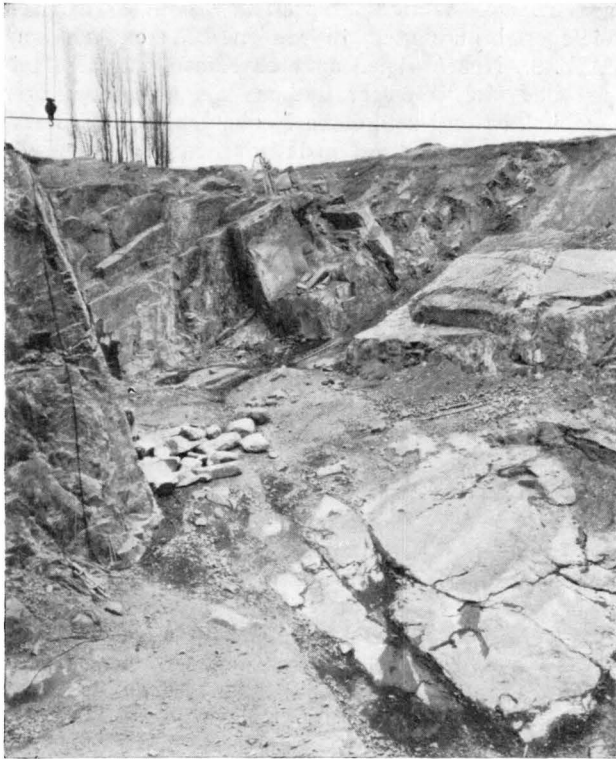
6 Abbau von Lamprophyr (sog. Lausitzer Syenit Schneeflocke) im Steinbruch der Fa. Dr. Grosser & Co. bei Oberottendorf/Oberlausitz
